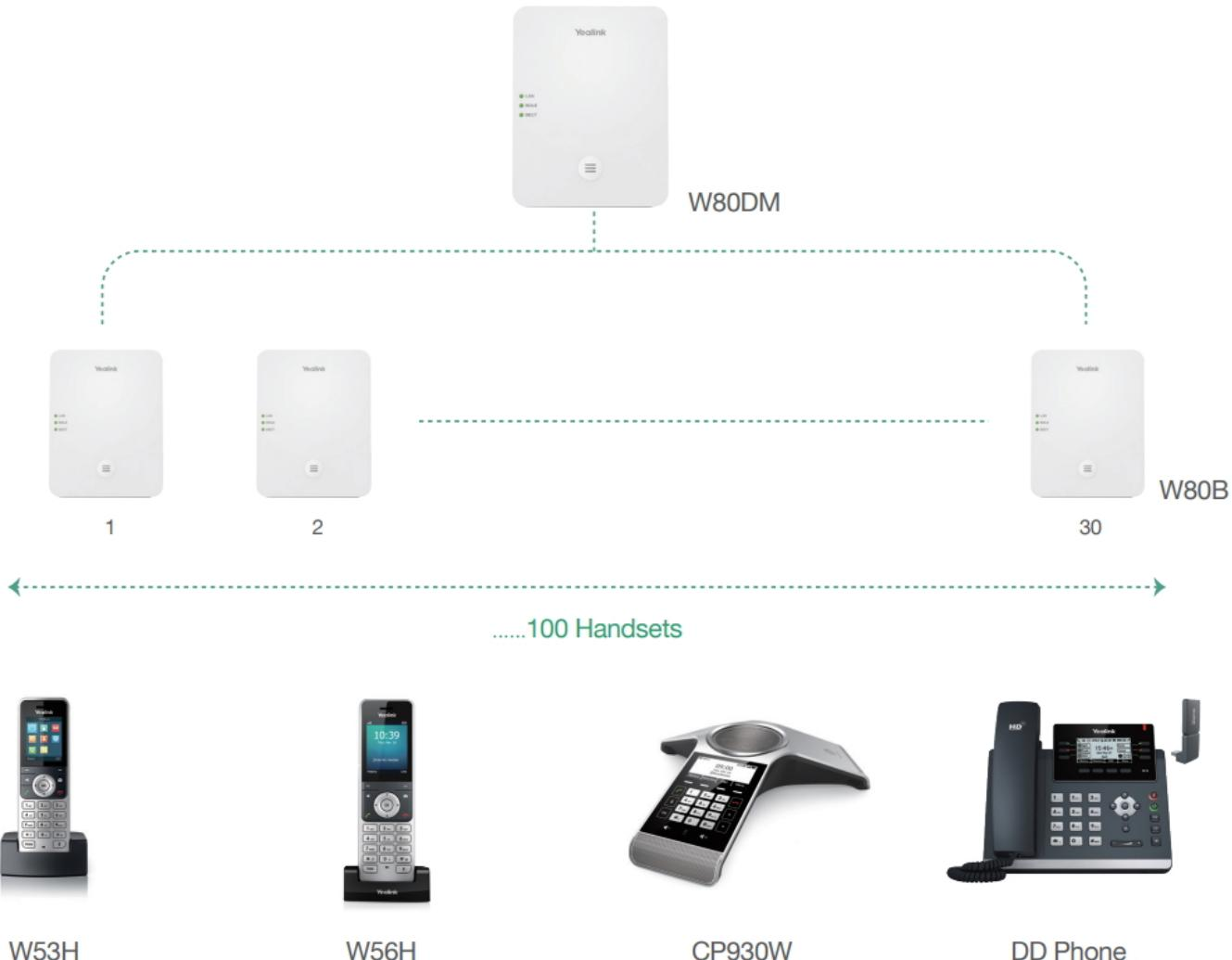
Yealink W80DM je centrální řídicí jednotka pro DECT systém Yealink. Umožňuje **správu až 30 základnových stanic W80B**. Zajišťuje plynulý roaming a handover, centrální konfiguraci a bezpečné šifrování komunikace. Technologie **Yealink DECT** se zaměřuje na vysoce kvalitní audio VoIP (širokopásmové) a datové aplikace s nízkou přenosovou rychlostí. Není však kompatibilní se zařízeními DECT jiných výrobců (základnová stanice, sluchátko atd.).
